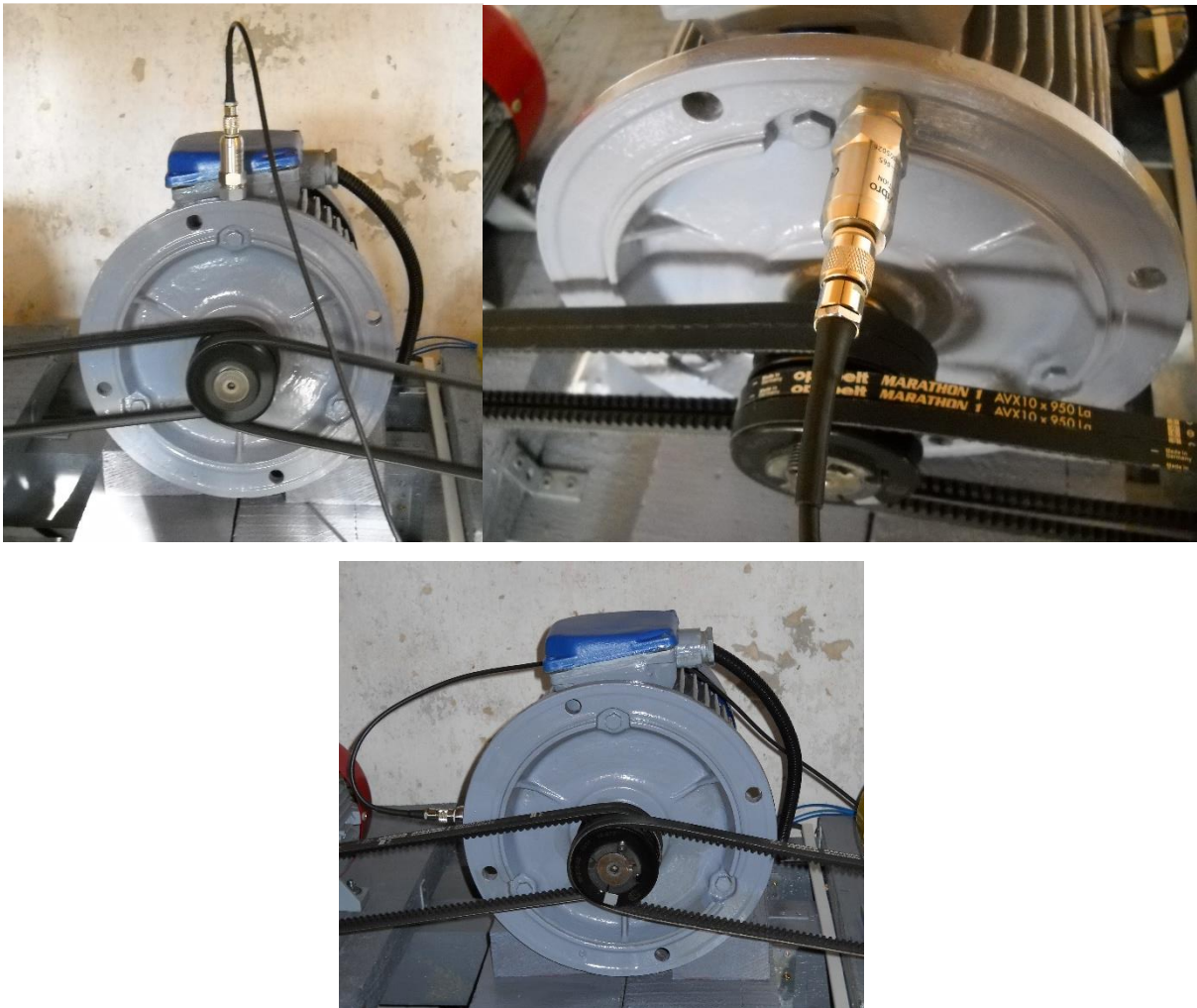
1. ábrák. A rezgésmérő szenzor elhelyezése.
