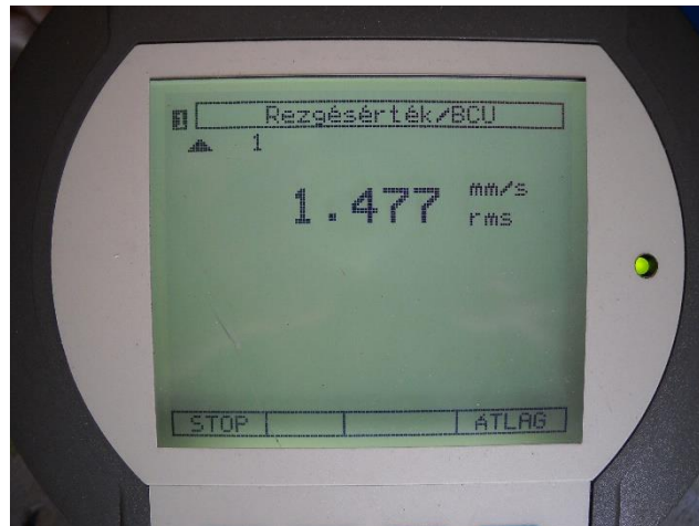
3. ábra. Függőleges irányban fellépet rezgésérték.
