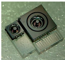
1. ábra – az MFA MEMS laboratóriumában fejlesztett 3D erőmérők.
