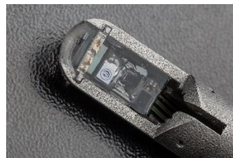
3. ábra – sebészcsipesz a beültetett erőmérővel.
