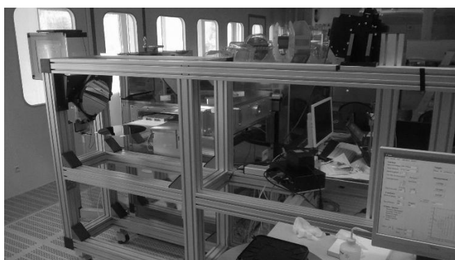
1. ábra Installált térképező berendezés és NiSi réteg vastagság-térképe 300 mm átmérőjű Si-szeleten
