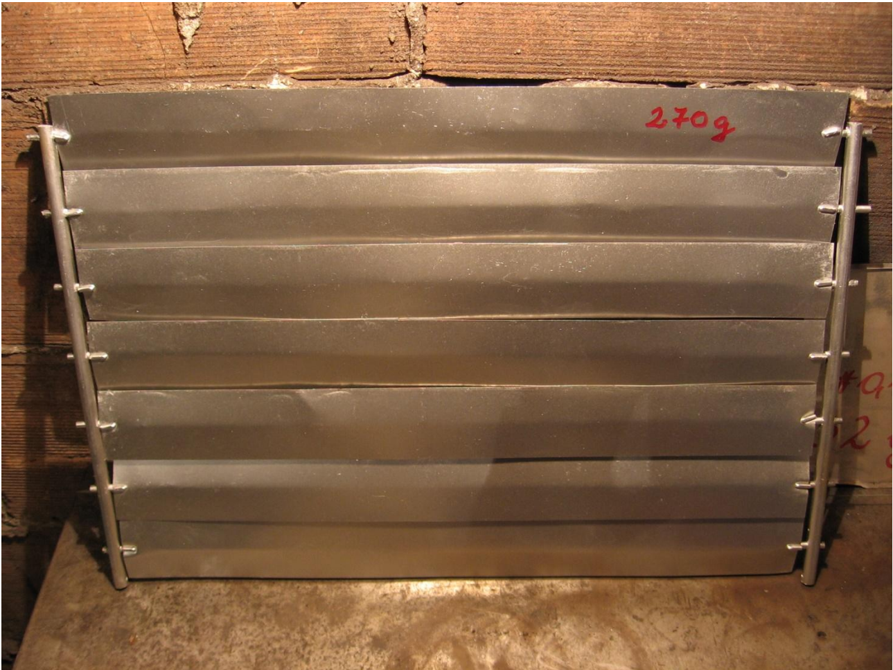
8. A részekre bontott érzékelő, mellyel a hatáskeresztmetszet változtatható
