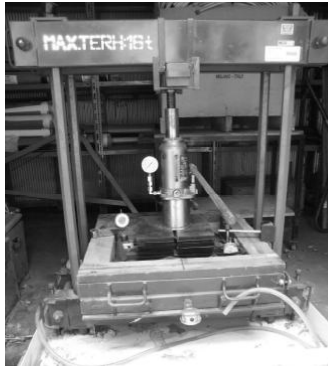
8. ábra Kompressziós kísérlet
