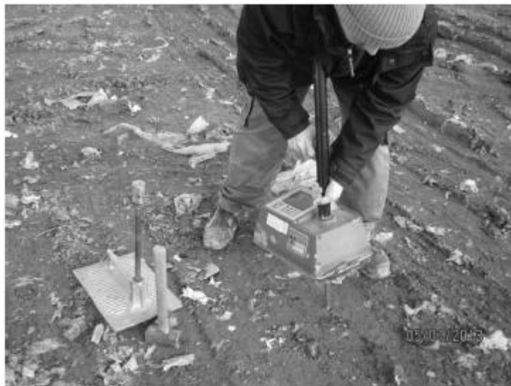
7. ábra Izotópos tömörségmérés.
